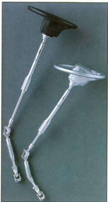
De samendrukbare stuurkolom voorkomt ernstig letsel bij frontale aanrijdingen.
