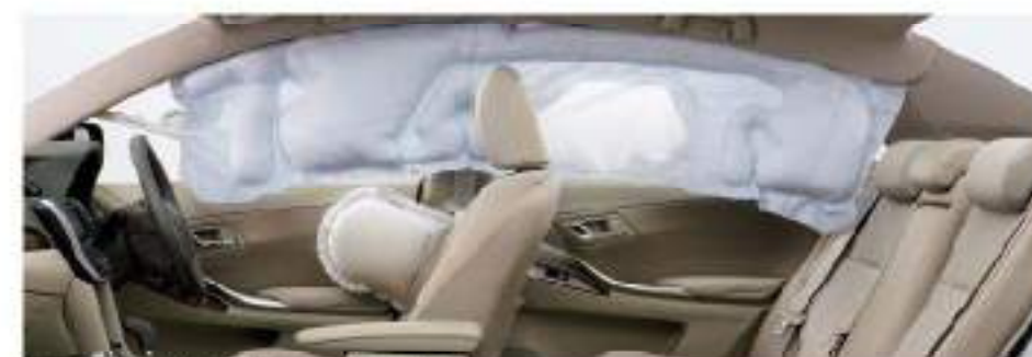
SRSサイドエアバッグ&SRSカーテンシールドエアバッグ （2.0G*「SUPERIORパッケージ」に標準装備、その他にメーカーオプション）
