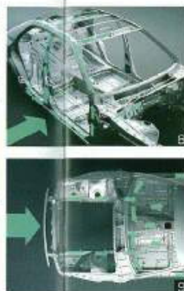
■オフセット側面衝突実験(50km/h)*写真は実験用試作車です。 ■側面衝突実験(50km/h)*写真は実験用試作車です。 ■サイドフアーム(写真は説明のため着色したものです) ■衝突吸収ボディ&高強度キャビン*GOA*(側面) ■衝突吸収ボディ&高強度キャビン*GOA*(前面) ■全席ELR付3点式シートベルト(前席プリテンショナー&フォースリミッター機構付・後左右席チャイルドシート固定機構付)
