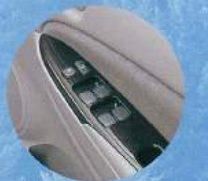
パワーウィンドウ (運転席ワンタッチ式・挟み込み防止機構付) &木目調スイッチベース(ダークグレー)
