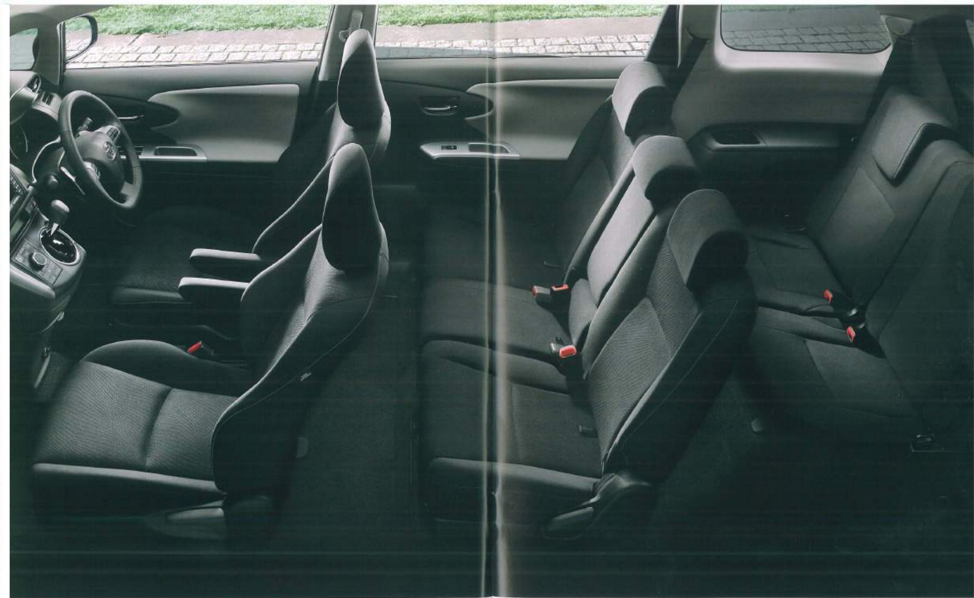
Photo: WISH 1.8S (2WD)。内装色はダークグレー。HDDナビゲーションシステム、 ワイドビューフロントモニター+インテリジェントパーキングアシスト、スマートエントリー&スタートシステムはメーカーオプション。 ●写真は発売説明のためにボディの一部を切断したカットモデルです。
