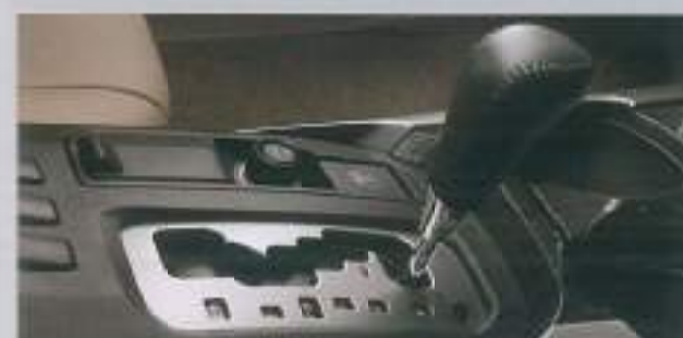
ゲート式A/Tシフトレバー スポーティな操作感覚が楽しめるゲート式を採用。 また、SSR-Gにはしっかりと手に伝わる本革製シフトノブを採用。
