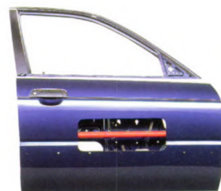
Beschermingsbalken in alle deuren, die bescherming bieden bij een zijwaartse aanrijding, zijn standaard in alle modellen.
