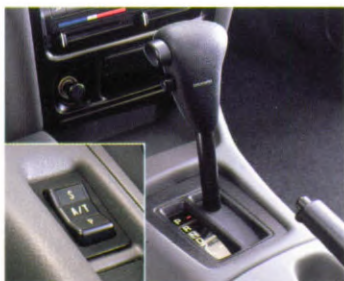
De automatische vierversnellingsbak heeft een "normaal", een "power" en een "snow"-programma voor superieure prestaties en een laag brandstofverbruik bij verschillende rij-omstandigheden. (1.6 en 1.8 modellen)
