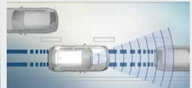
□ **Driving Assistant<sup>4</sup>** combina el aviso de salida de trayecto y el aviso de colisión. Los avisos de colisión y de peatones con función de frenado en ciudad advierten<sup>4</sup>, a velocidades de entre 10 y 60 km/h, de posibles colisiones con vehículos o peatones y frenan en caso de emergencia. A partir de unos 70 km/h, el aviso de salida de trayecto advierte del abandono involuntario del carril con una ligera vibración del volante.
