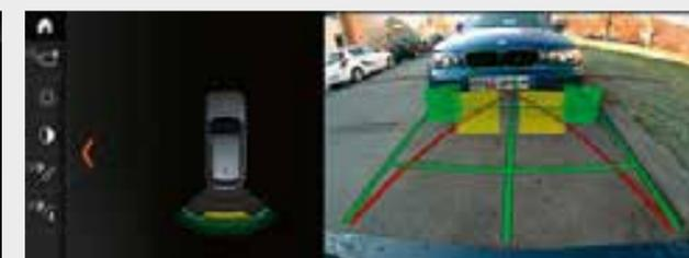
□ La cámara para marcha atrás<sup>9</sup> ofrece una mejor orientación al circular hacia atrás en las maniobras de aparcamiento y a velocidades inferiores a 15 km/h. Muestra en el display de control la zona situada detrás del vehículo. Unas marcas de carril interactivas que indican la distancia y el radio de giro apoyan al conductor en las maniobras, y los obstáculos se indican en color.
