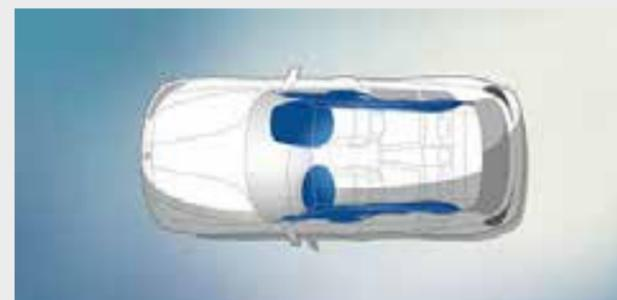
■ Los **airbags** para conductor y acompañante forman parte de los componentes de seguridad óptimamente coordinados entre sí de un BMW. Un total de seis airbags ofrecen protección selectiva: airbags para el conductor y el acompañante, airbags de cabeza para toda la superficie de las ventanillas laterales y airbags laterales en los respaldos de los asientos delanteros.
