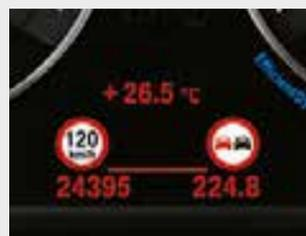
□ El Speed Limit Info<sup>2, 9</sup> con indicación de prohibición de adelantar informa de los límites de velocidad y las prohibiciones de adelantamiento, y los muestra en el display de información del cuadro de instrumentos.
