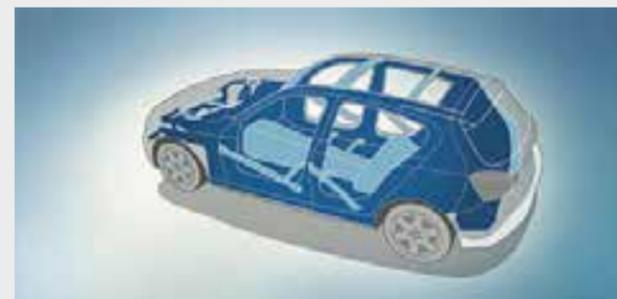
■ El **habitáculo ofrece**, gracias a la estructura funcional con soportes especiales y elementos de unión, así como al uso puntual de materiales de elevada resistencia, una seguridad pasiva óptima en caso de impacto frontal, lateral o por alcance.
