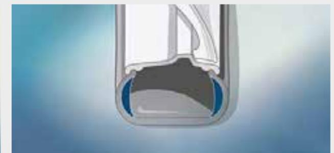
□ Los **neumáticos con funcionamiento en caso de avería**, gracias a sus flancos reforzados, no se desprenden de la llanta cuando sufren algún daño, lo que permite proseguir el viaje hasta el taller más cercano.
