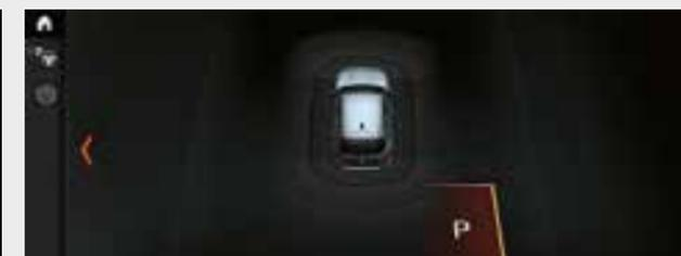
□ El asistente de aparcamiento<sup>8</sup> facilita el aparcamiento paralelo y transversal a la calzada. Para ello, el sistema mide las plazas de aparcamiento al pasar por delante a baja velocidad. Si encuentra una lo bastante amplia, asume el movimiento del volante y el conductor solo tiene que seleccionar la marcha, acelerar y frenar.
