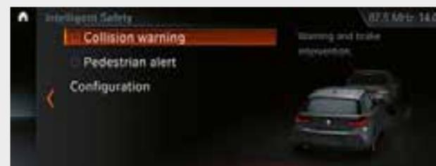
□ Driving Assistant<sup>9, 12</sup> combina el aviso de salida de trayecto y el aviso de colisión. Los avisos de colisión y de peatones con función de frenado en ciudad advierten<sup>8</sup>, a velocidades de entre 10 y 60 km/h, de posibles colisiones con vehículos o peatones y frenan en caso de emergencia. A partir de unos 70 km/h, el aviso de salida de trayecto advierte del abandono involuntario del carril con una ligera vibración del volante.
