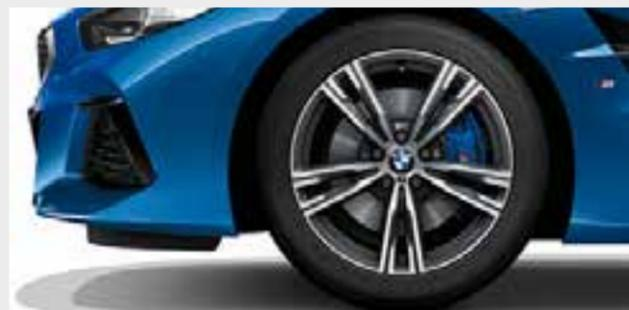
□ Llantas de aleación ligera M de 18 pulgadas con radios dobles estilo 798 M, en bicolour Orbitgrau, con neumáticos de distintas medidas, pulido brillante, delante 9 J x 18, neumáticos 255/40 ZR 18, detrás 10 J x 18, neumáticos 275/40 ZR 18.<sup>2,5</sup>
