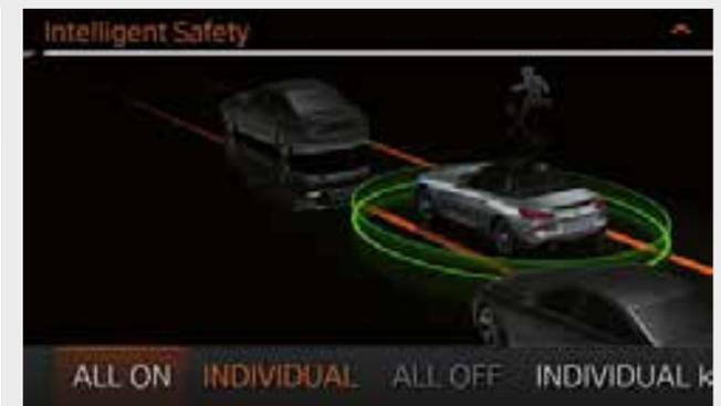
□ El paquete de seguridad Driving Assistant<sup>2,3</sup> ofrece avisos de colisión y de peatones con función de frenado en ciudad y Speed Limit Assist, que incluye Speed Limit Info con indicación de prohibición de adelantar y previsión, así como aviso de salida de trayecto. Además, los equipamientos basados en radar cuentan con aviso de tráfico trasero, advertencia de cambio de carril y aviso de colisión por alcance.
