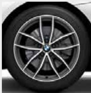
□ Llantas de aleación ligera de 18 pulgadas con radios en V estilo 770 en bicolour Orbitgrau, con neumáticos de distintas medidas, pulido brillante, delante 8 J x 18, neumáticos 225/45 ZR 18, detrás 9 J x 18, neumáticos 255/40 ZR 18.<sup>1,3</sup>
