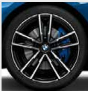
□ Llantas de aleación ligera M de 19 pulgadas con radios dobles estilo 799 M, en bicolour Jetblack, con neumáticos de distintas medidas, pulido brillante, delante 9 J x 19, neumáticos 255/35 ZR 19, detrás 10 J x 19, neumáticos 275/35 ZR 19.<sup>4</sup>
