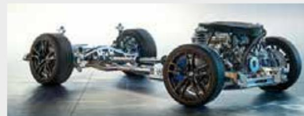
□ La suspensión M adaptativa<sup>1</sup> se ajusta electrónicamente a las condiciones de la calzada y a la situación de conducción. Además, el conductor puede ajustar las características de la suspensión mediante el sistema Driving Experience Control al estilo de conducción que prefiera en un momento dado: desde cómodo hasta marcadamente deportivo con una conducción aún más ágil.
