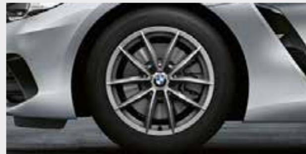
○ Exclusivas llantas de aleación ligera BMW de 17 pulgadas con radios en V estilo 768 en Ferricgrey con neumáticos de distintas medidas y funcionamiento en caso de avería, Ruedas completas de invierno RDC, delante 7,5 J x 17, neumáticos 225/50 R 17, detrás 8 J x 17, neumáticos 225/50 R 17.
