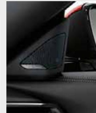
□ Sistema de sonido envolvente Harman/Kardon<sup>2</sup> con amplificador digital de 408 vatios, 7 canales, ecualización específica del vehículo y 12 altavoces.
