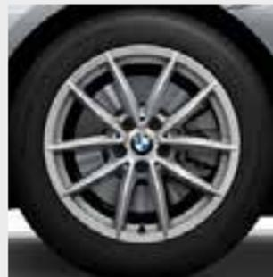
■ Llantas de aleación ligera de 17 pulgadas con radios en V estilo 768, en Reflexsilber, con neumáticos de distintas medidas y funcionamiento en caso de avería, delante 7,5 J x 17, neumáticos 225/50 R 17, detrás 8,5 J x 17, neumáticos 255/45 R 17.
